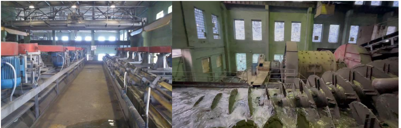
Abb. 2: Mahlen, Klassifizierung und Flotation von Graphiterz in der Anreicherungsanlage Zavaliievsky, April 2023
